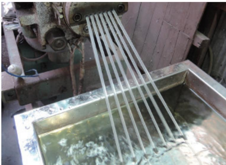
\* 65mmVベント式押出機は、製造時に出る廃プラスチックを再ペレット化する機械です。スクリーン内でゴミを取り除いてから、画像のように水槽で冷やし再原料化しています。着色なども自社で行えるため、受注後の納期を最短でお受けすることができます。
